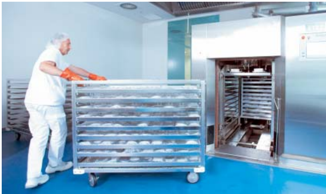
Wenn es raus kommt, ist es rein: Die fertigen Pharmaprodukte werden in die Sterilisationsanlage des neuen Technikums eingefahren. Foto: B. Braun
