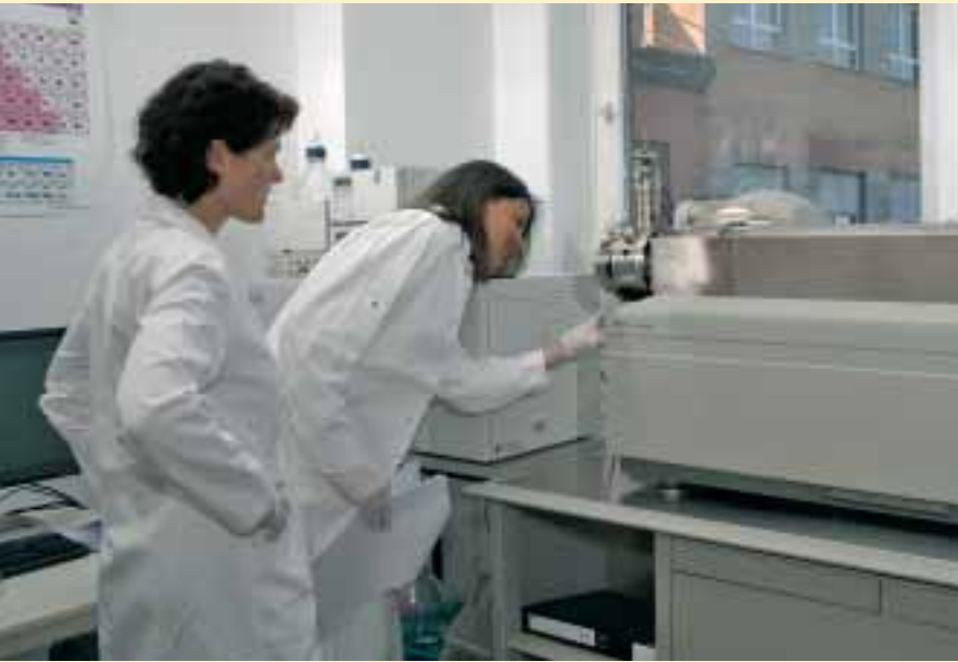
Effektive Verbindung: Prolytic koppelt Hochdruckchromatographie mit Massenspektrometrie, um Substanzen in extrem geringen Konzentrationen nachzuweisen. Foto: Studio courté
